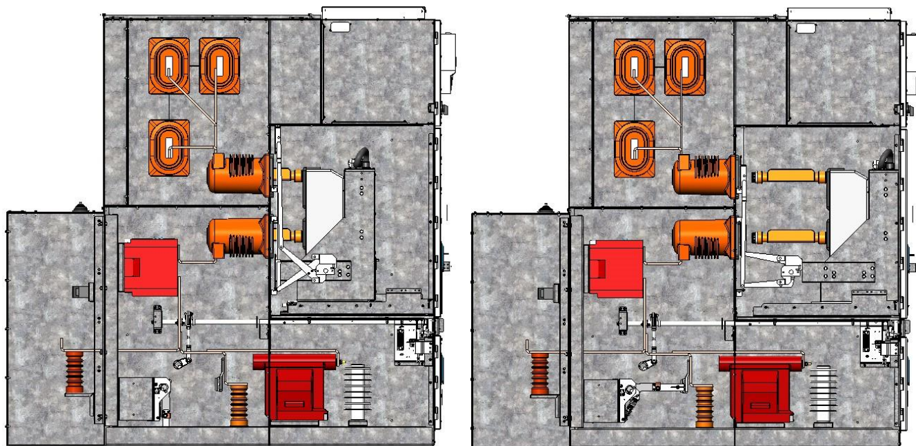
Рис. 7. Положения выкатных элементов на примере силового выключателя (слева – рабочее, справа – контрольное)
